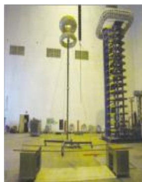
图 3 棒—线间隙实物图 Fig. 3 The real figure of rod-line clearance
